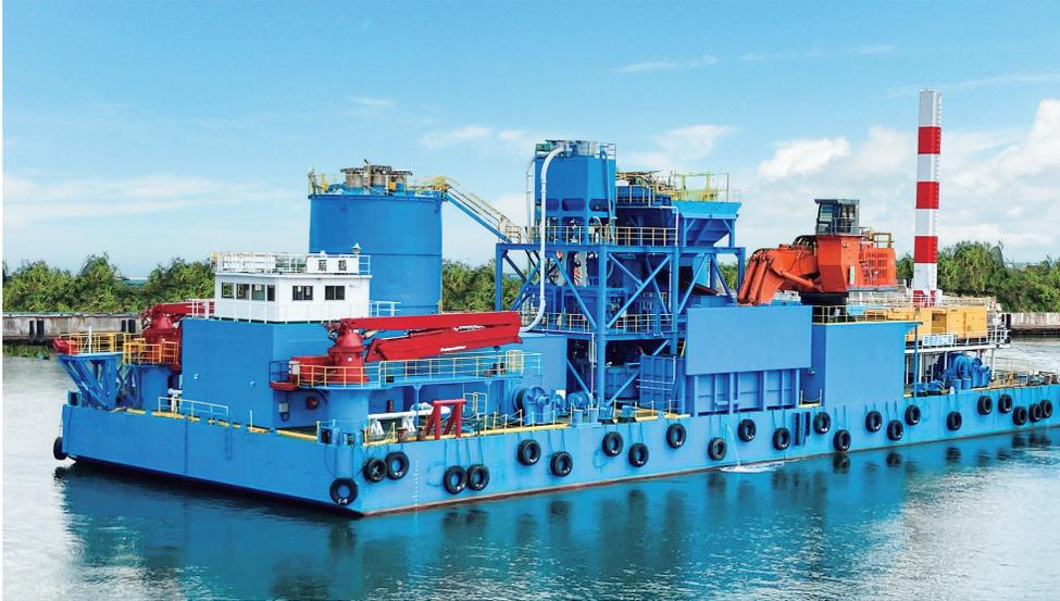
バッチ式は、混練槽内に1回分ずつ土砂とセメントを計量し、内部に装着した回転翼で練り混ぜる形式のもので、セメントは粉体添加としている。
