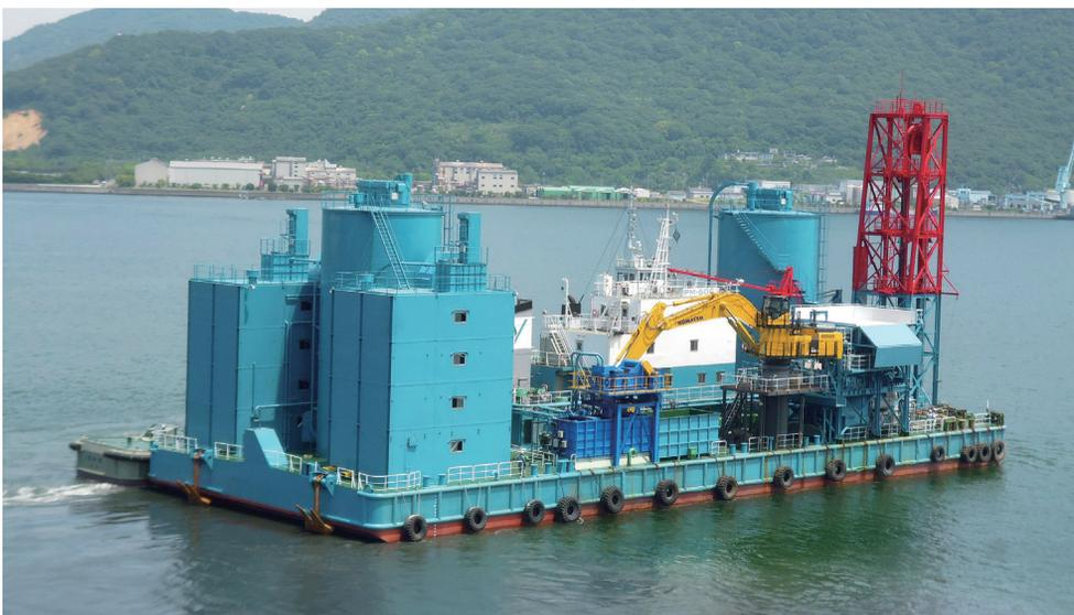
連続式は、パドル式ミキサーを土砂とセメントを一定流量供給しながら連続的に混合する方式で、セメントはスラリー添加としている。
